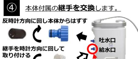
FW-AN08本体給水口の、黒いキャップと青い継手を反時計方向に回してはずします(はずした部品は、搬送時の水漏れ防止用に必要ですので、保管してください。)
